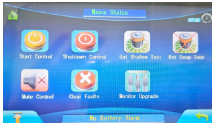
FIGURA 4.3 MENÚ CONTROL DE LA PANTALLA TÁCTIL DE UPS.
