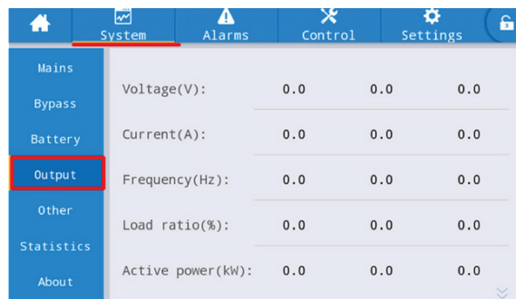
FIGURA. 4.9. INTERFAZ "OUTPUT", INFORMACIÓN DE SALIDA DEL UPS
